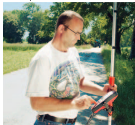
El SR20 tomando datos topográficos con precisión de centímetros mediante técnicas cinemáticas.
