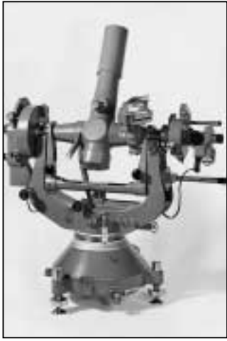
Der 1944 lancierte Wild T4 ist auch heute noch als genauestes feinmechanisch-optisches Instrument ein Begriff. Er wurde auch für Vermessungsaufgaben in den Anfangsphasen der amerikanischen Raumfahrt eingesetzt.
