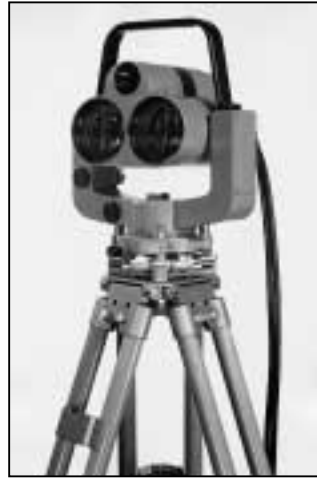
Der Infrarot-Distanzmesser Wild DI10 revolutionierte 1968 als erster reduzierender elektronischer Tachymeter die Vermessungstechnik.
