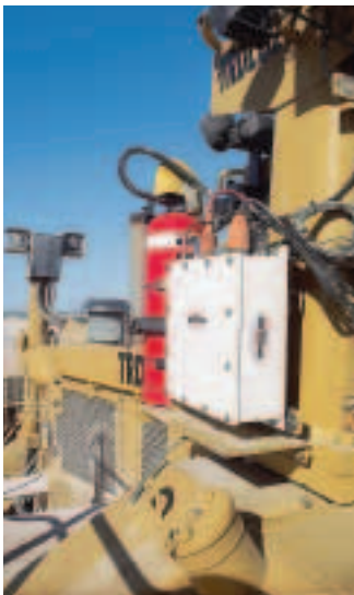
Die Kommunikationselemente des Leica Dozer 2000T sind ausserhalb der Kabine montiert.
