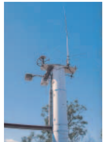
Die GPS-Basisstation übermittelt Daten an den Rover.
